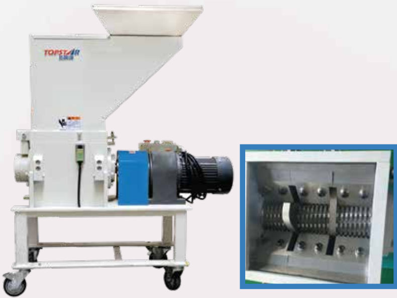
MACCHINA ALIMENTATA CON MATERIALE MACINATO IMM FEED WITH REGRINDED MATERIAL
