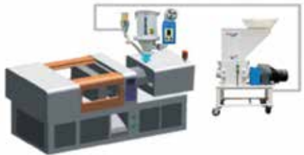
MACCHINA ALIMENTATA CON MATERIALE MACINATO IMM FEED WITH REGRINDED MATERIAL
