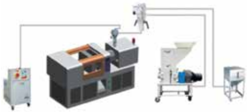
ALIMENTAZIONE CON MISURA DI MATERIALE VERGINE E MACINATO IMM FEED WITH VIRGIN + REGRINDED MATERIAL
